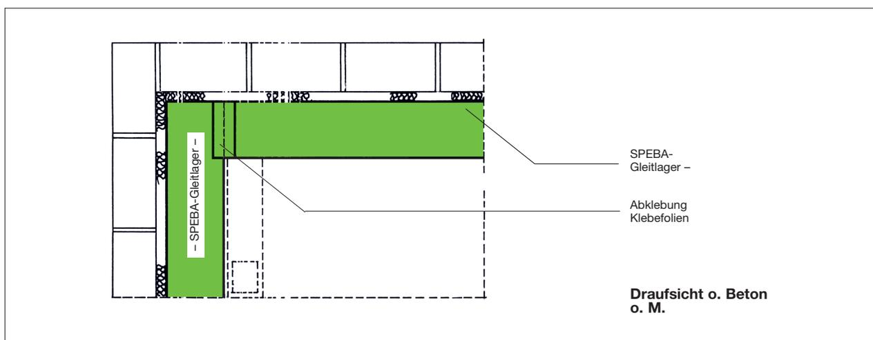
Die Auflagerfläche auf dem Mauerkopf ist sauber und eben abzureiben und von Fett und körnigem Material zu säubern. Um die Bewegungsfreiheit zu gewährleisten, sollte die Unterkante der fertigen Decke gleich der Oberkante des Lagers sein.
