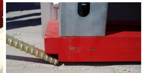
Hebelkante im Gleitrahmen
