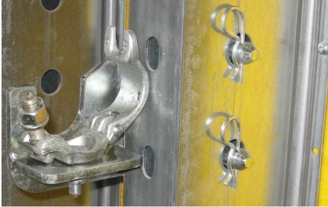
Geöffneter Adapter für Gerüstrohr
