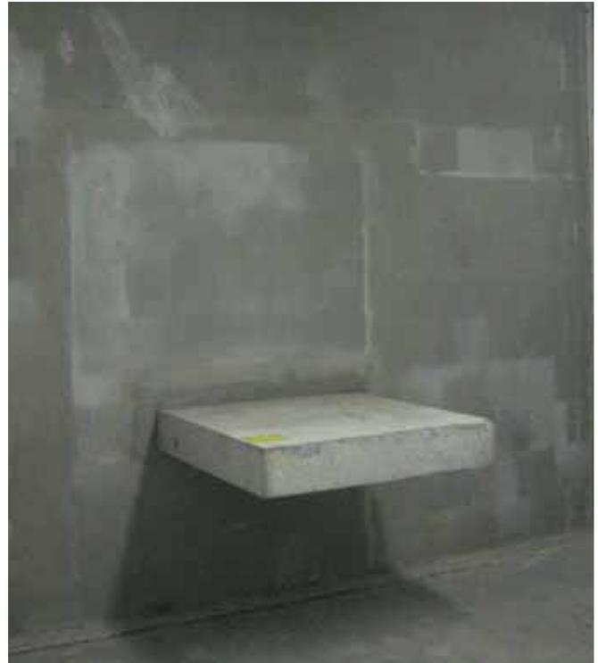
Prüfstand in Anlehnung an DIN EN ISO 10140 mit eingebautem Element
