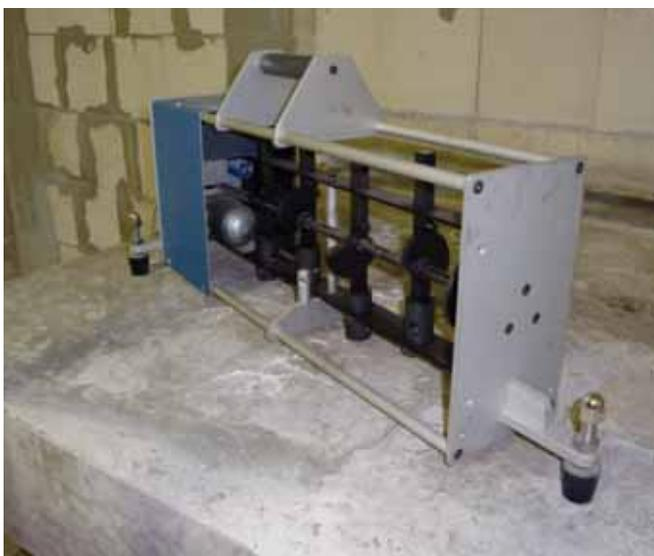
Normhammerwerk nach DIN EN ISO 10140
